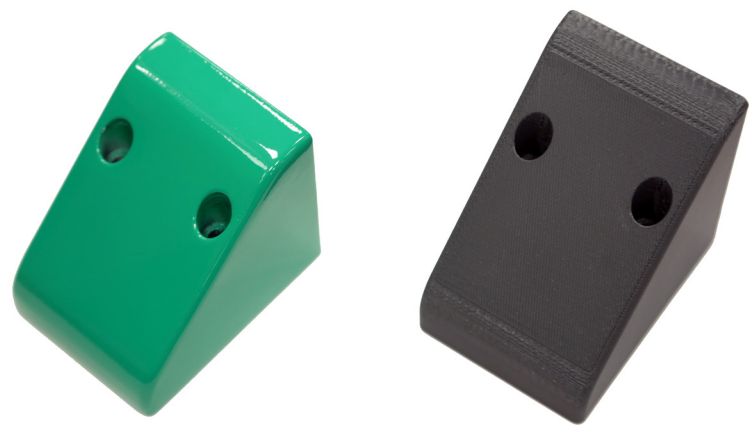
Mit 3D-Druck gefertigte stabile und dennoch leichte Schutzgehäuse für Roboterpackungsmaschinen. Hergestellt aus dem Material FDM Nylon 12CF mit der Fortus 450mc von Stratasys und am Ende grün lackiert.
